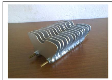
Con los rotores y estatores ensamblados, seguiremos con la confección de las tapas, sobre las que sujetaremos los primeros, para ello usaremos metacrilato de 4mm de espesor, con el que haremos unas piezas de 90x110mm. Taladraremos en las esquinas con una broca de 8mm y en el centro con una bailarina de 19mm para insertar un retén de 19mm ext. y de 6mm interior, posteriormente realizaremos los dos taladros de 4mm para los ejes de los estatores.
