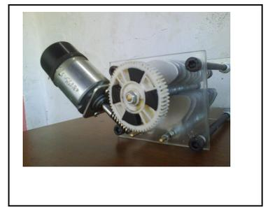
En la siguiente imagen tenemos nuestro condensador variable completamente montado y con sus conectores, listo para ser instalado.
